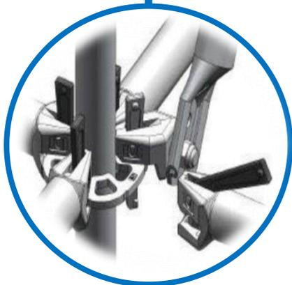
圆盘式多功能脚手架。这种脚手架的插座为直径133mm、厚10mm的圆盘，**圆盘上开设8个孔**，立杆是在一定长度的钢管上每隔0.60m焊接上一个圆盘，用这种新颖、美观的圆盘连接横杆，底部带连接套。横杆是在钢管两端焊接上带插销的插头制成。
